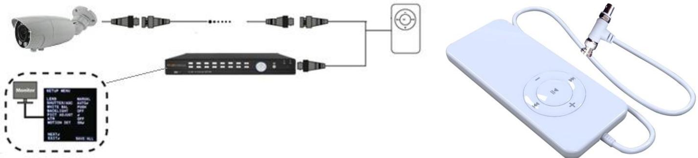
Подключение **SNR-CA-UTC** и вид кнопок контроллера.
