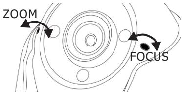
Настройку производить шлицевой отверткой
