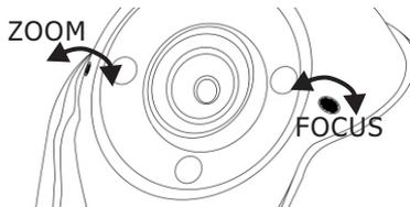
Настройку производить шлицевой отверткой
