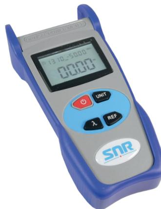
Портативный оптический измеритель мощности оптического излучения для диапазона частот от 800 до 1700nm
