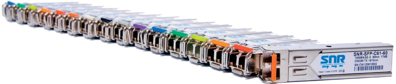
Для организации 1G-каналов (GigabitEthernet, FibreChannel) оптические модули SFP CWDM марки **SNR** бывают с бюджетом 17/25/32 и 41dB, для 2.5G-каналов (STM-16/OC-48) – 18..35dB, для 10G-каналов (10GbE, 8/10G FibreChannel, STM-64) – 10..24dB, позволяя тем самым организовывать и достаточно протяженные линии.
