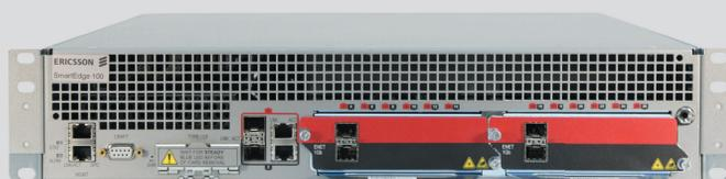
Мультисервисные маршрутизаторы **Ericsson SmartEdge** - идеальное решение для применения в качестве BRAS в сети малого оператора. Позволяют терминировать IPv4, IPv6 и DualStack абонентов по IPoE L2, IPoE L3, PPPoE и L2TP. Высокопроизводительные ASIC PPA2 позволяют выполнять аппаратный NAT абонентского трафика на скорости портов. Carrier Grade NAT дает возможность выполнять трансляцию адресов в режиме Paired mode поверх агрегированных линков.
