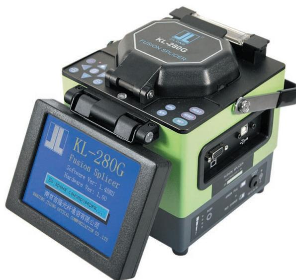
Автоматический сварочный аппарат KL-280G сегодня является самым бюджетное решение по сварки оптоволокна. Позволяет работает со всеми типами волокон, улучшенная система выравнивания волокна по сердцевине (технология PAS), работа в диапазоне от -10С до +50С, один заряд батареи на 160 сварок/усадок.
