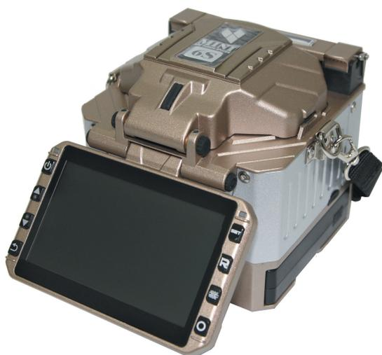
Автоматический сварочный аппарат **Mini 6S** - высокотехнологичная разработка компании FIBERFOX. Mini 6S оснащен механизмом контроля волокон по сердцевине DWACAS (Digital Wavelength Automatic Core Alignment System), а также системой точного мониторинга потерь по осям (X,Y,Z) и режимом автокалибровки дуги.
