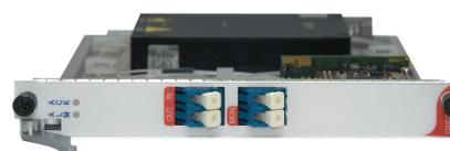
**Orion EP2520** – карта EDFA предусилитель (pre-amplifier), усиление 25dB, выходная мощность до 20dBm, занимает 1 слот.
