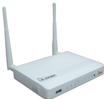
Модель **LR-25G001** - это wi-fi-маршрутизатор со встроенным гигабитным коммутатором, что позволяет передавать большие объемы трафика в пределах дома и офиса за короткое время. Также, данная модель поддерживает 2 диапазона частот: 2.4ГГц и 5ГГц, что позволяет использовать менее зашумленный диапазон для клиентских устройств с поддержкой 802.11a/an.
