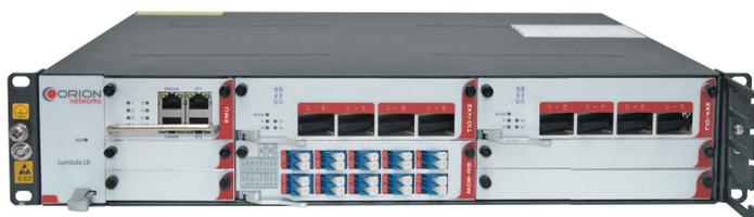
**Orion L8** – 2U 19” шасси с возможностью установки до 8 сервисных карт. По умолчанию комплектуется модулем управления и двумя блоками питания AC или DC.
