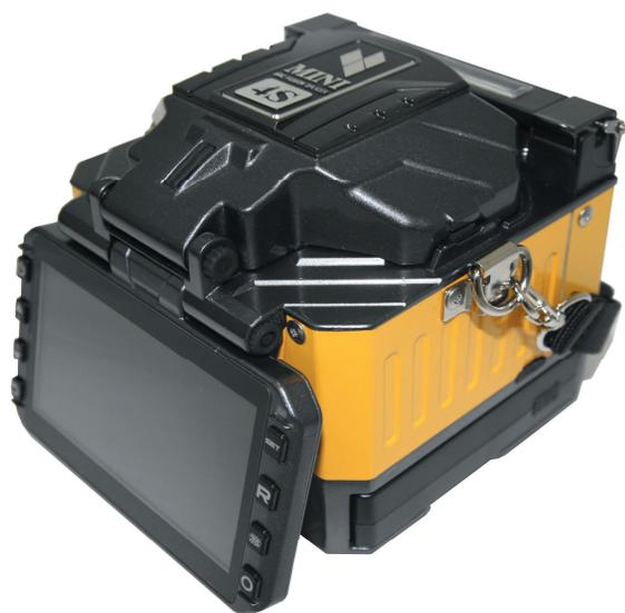
Автоматический сварочный аппарат **Mini 4S** - это современное оборудование, предназначен для сварного соединения оптических одно и многомодовых волокон. Прибор оснащен механизмом сведения волокон по сердцевине DCA (Digitalized Cladding Alignment). Сварочный аппарат Mini 4S разработан для работы в FTTx проектах, его превосходная мобильность и надежность обеспечивает удобство работы в любом месте.
