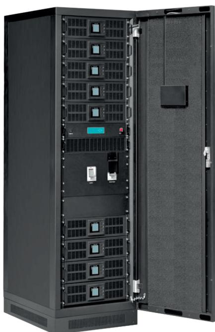
Модульный ИБП серии НРМ представляет собой стойку, в которую устанавливается до 10 модулей различной мощности (10 кВА, 15 кВА, 20 кВА), что позволяет наращивать мощность стойки с появлением дополнительного оборудования в системе энергоснабжения. Общая мощность модульной системы может достигать 200 кВА, что обусловлено возможностью соединять модульные стойки в параллель до 4 штук.
