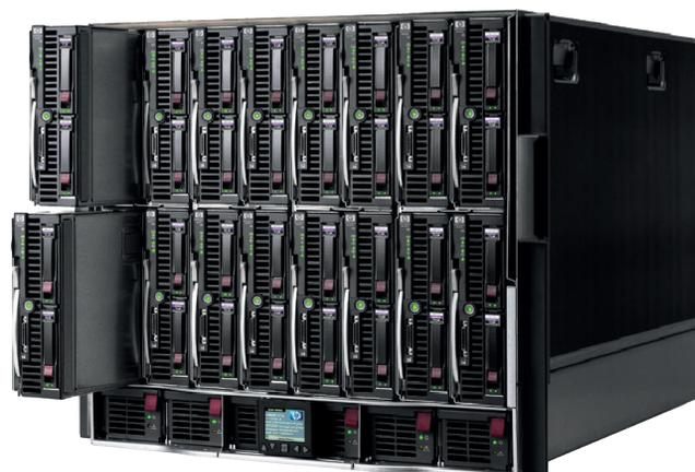
Устройства данной группы представляют из себя модульные решения обычно до 14-16 серверов установленных в единое шасси форм-фактора 7-10U. Каждый отдельный модульный микро-сервер в такой системе традиционно называется “лезвием” или “блейдом” (blade).
