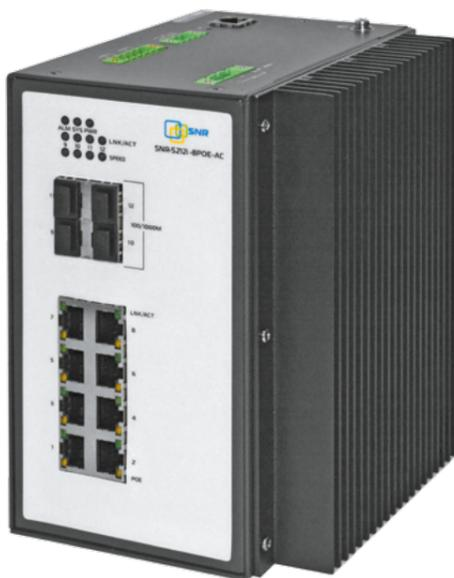
Коммутатор оснащен 8-ю портами 10/100BaseTX с поддержкой POE, 4-мя портами 100/100BaseX SFP, а также входами и выходом для подключения устройств мониторинга и оповещения.
