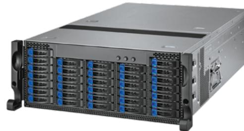
Серверы рассчитаны на применение в качестве серверов хранения данных с ёмкостью до 288ТБ, систем видеонаблюдения с большой глубиной архива.
