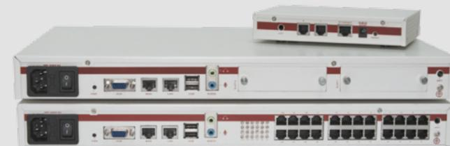
IP АТС линейки **LVX** – это универсальное решение для обеспечения связью предприятий малого и среднего бизнеса. Линейка LAVoice LVX представляет собой серию гибридных IP-PBX на базе Asterisk 1.8 модульной архитектуры различной емкости: от 30 до 500 SIP-регистраций, до 24 аналоговых интерфейсов FXS/FXO.
