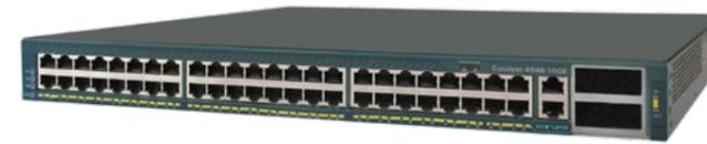
Коммутатор на базе 4500 каталиста с широчайшим функционалом L2, L3, L4 и расширенными ресурсами TCAM (64 000 записей) 48 портов 1G и 2 порта 10G.
