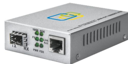
Предполагает установку на узлах, где немного PoE-устройств и где нецелесообразно устанавливать дорогостоящие PoE-коммутаторы со множеством портов.
