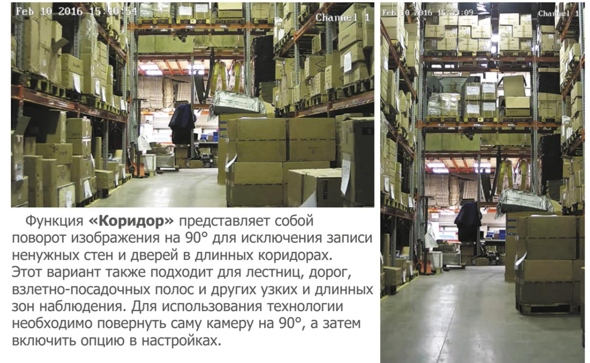
Функция «Коридор» представляет собой поворот изображения на 90° для исключения записи ненужных стен и дверей в длинных коридорах. Этот вариант также подходит для лестниц, дорог, взлетно-посадочных полос и других узких и длинных зон наблюдения. Для использования технологии необходимо повернуть саму камеру на 90°, а затем включить опцию в настройках.
