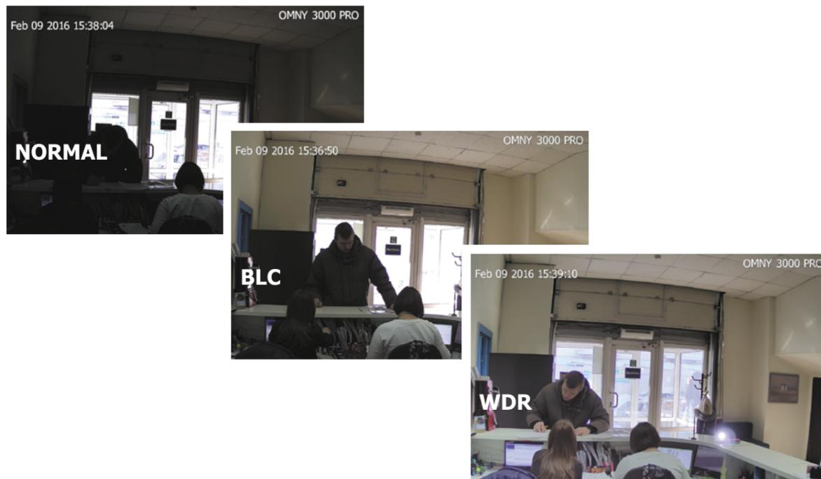
Специальная функция **BLC** (англ. Back Light Compensation, компенсация заднего света) - базовая составляющая WDR.
