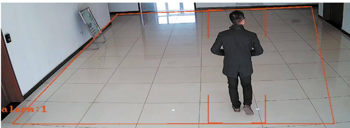
Новым вызовом современной цивилизации стал терроризм. Специальный функционал камер OMNY рассчитан в первую очередь на борьбу с этой угрозой. Камера определяет любой оставленный определенное время предмет на заданной территории, позволяя соответствующим службам реагировать максимально быстро. Также функция превосходно работает для целей дорожных служб. Она автоматически регистрирует остановку и парковку автомобилей в неполюженном месте.
