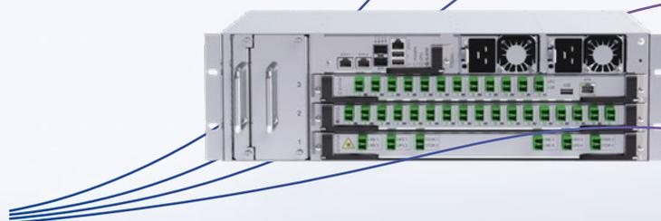
**Рефлектометр компании Т8** – это устройство для мониторинга, инвентаризации и автоматизации обслуживания линий связи.
