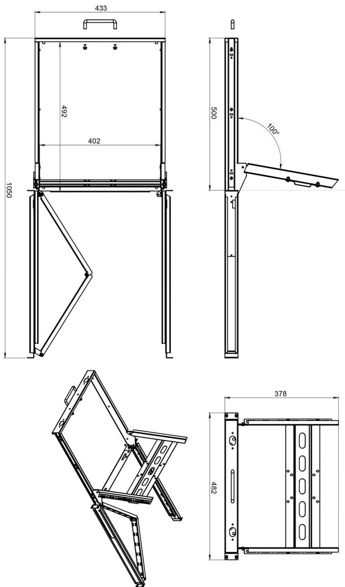
Рисунок 5 - Чертёж полки в рабочем положении
