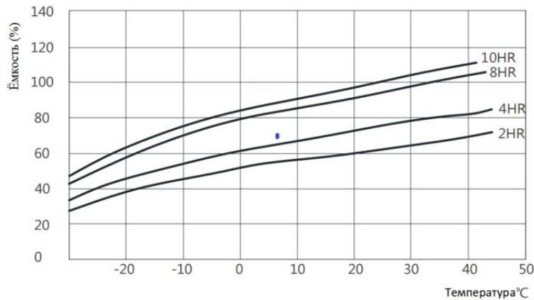
Рисунок 3 - Кривая саморазряда при различных температурах
