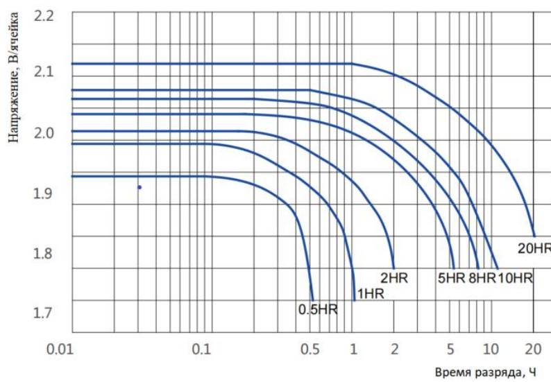
Рисунок 1 - График зависимости напряжения от времени разряда при температуре 25°C
