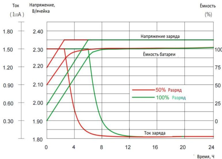
Рисунок 2 - Характеристики заряда при температуре 25 °C
