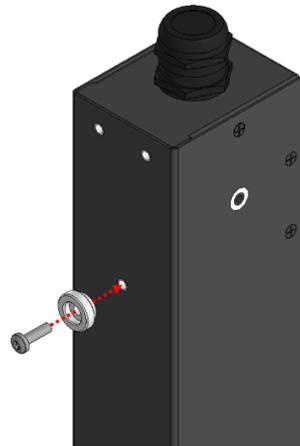
2. Вставьте оба ролика в отверстия, расположенные на кабельной трассе монтажного шкафа.
