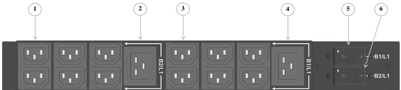
Рисунок 2 – Блок розеток iPDU-6031, передняя панель (один вариант исполнения):
