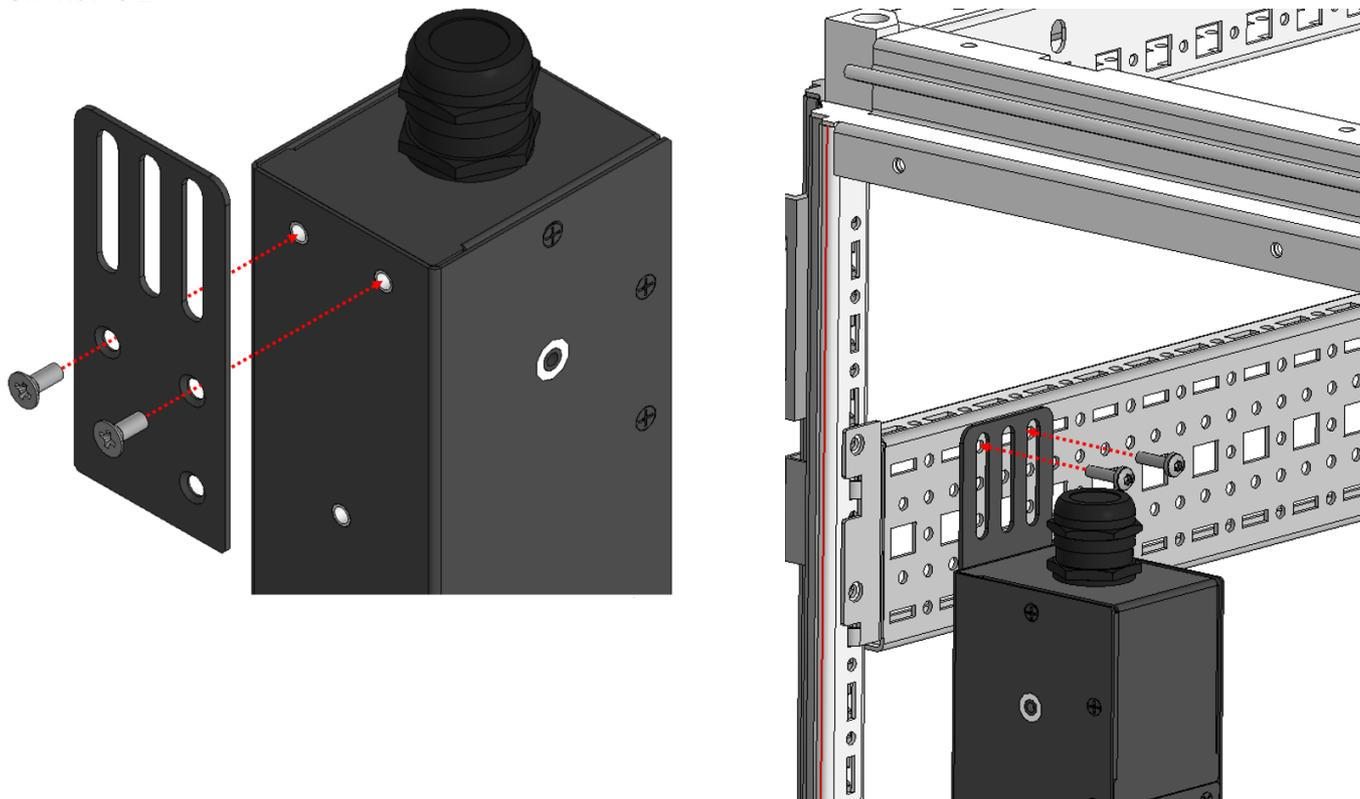
2.2 Монтаж устройства на вертикальную раму каркаса монтажного шкафа (могут быть применены и угловые кронштейны с перфорацией с шагом 25мм).
