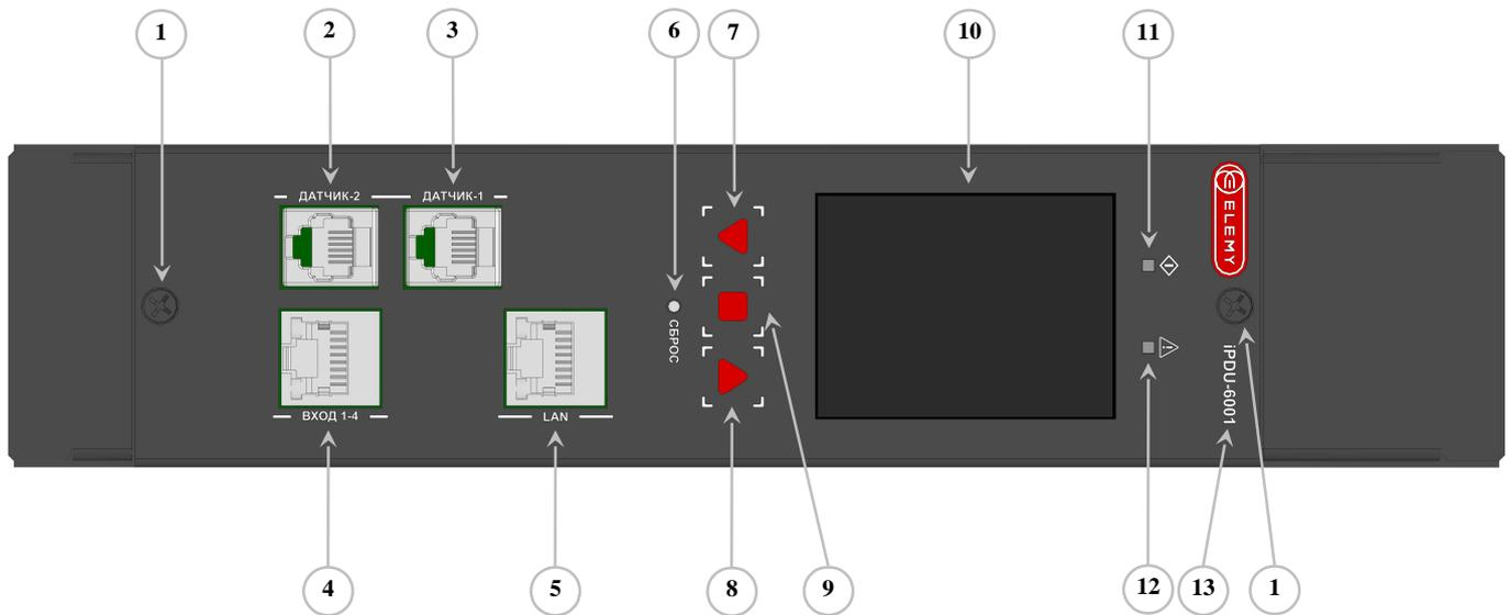
Рисунок 1 – Блок управления iPDU-6000, передняя панель:
